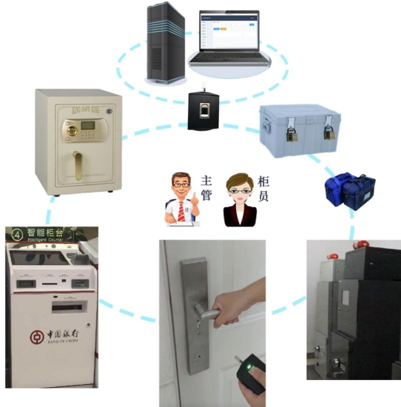
莎普科技智能锁群管理系统，可覆盖现金中心和辖区内所有网点，通过安全的接口和授权，也可以拓展到押运公司，方便的实现任务下载和押运人员的随机分组，它将实物箱包专用无源电子锁与网点和网点人员绑定，通过后台进行长期授权、周期授权和按具体日期授权等多种授权模式，使各岗位、各职级人员通过本网点的一把或几把指纹钥匙能便捷的开启自己所辖的款箱并保留痕迹，管理人员可根据需要查询开箱信息，使网点、押运公司、现金中心，有机的结合成为一个整体系统的组成部分。本系统的应用将各网点的日常业务完善化、制度化、标准化，安全化、简便化，同时是一个辅助领导决策并可提供考核参数的智能化
